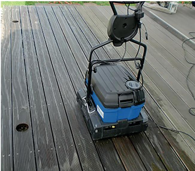
Der Bürstenreiniger ist besonders für die Auffrischung von Holz-Terrassenböden wie z. B. Bangkirai geeignet und kann des Weiteren auch zur Reinigung stark beanspruchter Industrie- und Gewerbeböden eingesetzt werden.
